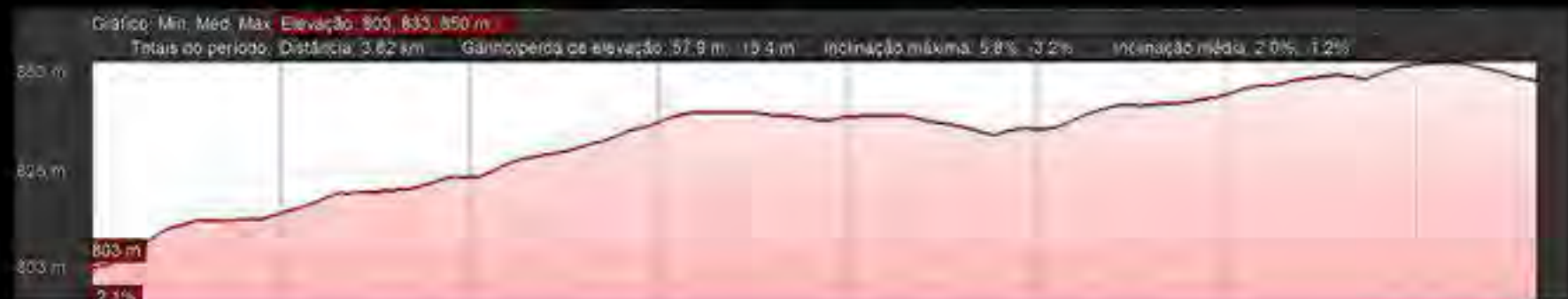
IMG. 08. PERFIL TOPOGRÁFICO DA LINHA DE LIMITE DA LINHA FÉRREA. INCLINAÇÃO MÉDIA DE 1.6%
